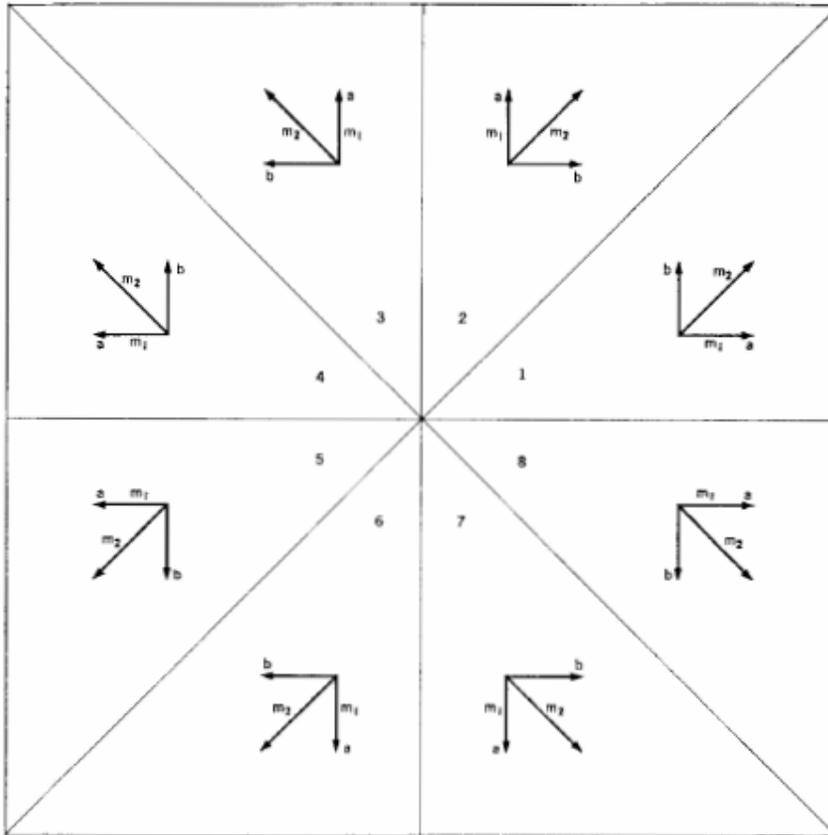
Für andere Oktanten müssen einfach  $\Delta a$  und  $\Delta b$  nach einem anderen Schema berechnet werden und die Bewegungsrichtungen anders interpretiert werden. Wie kommt Bresenham auf dieses Ergebnis?
